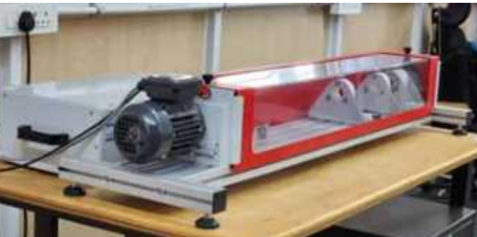
शाफ्ट ध्रुवीकरण एवं क्रिटिकल स्पीड उपकरण The whirling of Shafts and Critical Speed Apparatus
